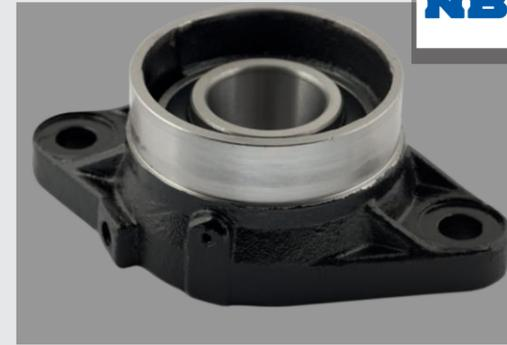
Gehäuselagereinheiten für den Einsatz in Häckslern und Mulchern. **Kundenindividuelle Sonderlager 2-Loch Flansch- und 4-Loch Flansch-Einheiten.** Gehäuse-Ausführungen in Sphäroguss GJS (GGG) und Stahlguss GS 52. Einsätze in NBR Premium-Qualität ABEC 3 / P6.
