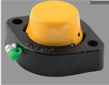
**2-Loch Flanschlager mit verstärktem Gehäuse** aus Sphäroguss GJS (GGG). Einsatz mit Innenring geführter metallischer Zusatzdichtung. Beidseitig Außenring geführte 3-Lippen Dichtungen. Abdeckkappe gegen grobe Verunreinigungen.
