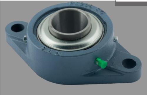
**2-Loch Flanschlager** aus Sphäroguss GJS (GGG). Einsatz mit metallischer Deckscheibe und anvulkanisierter Perbunandichtung, schleifend auf dem Außenring. Mehrfachabdichtungen Außenring geführt. Fettbefüllung 70 % mit Langzeitschmierstoff Wälalit LZ 2. Lebensdauerschmierung.
